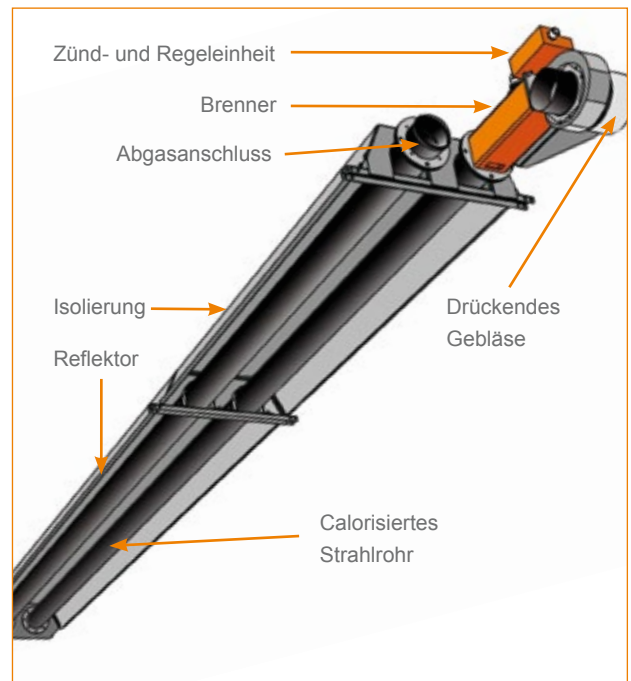
Gasbetriebener Infrarot-Dunkelstrahler
