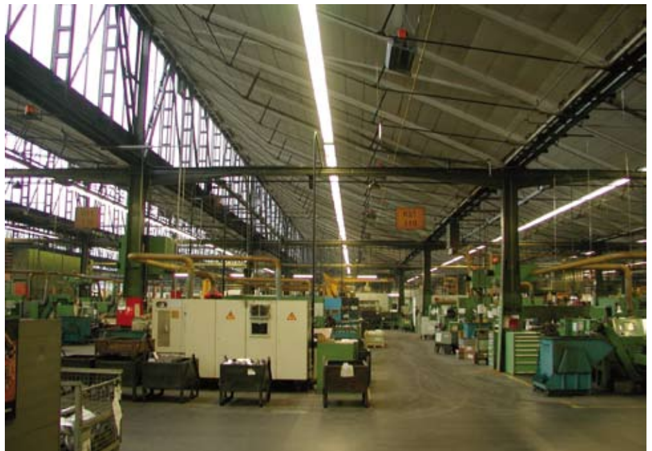
Bild 2: Hellstrahler verhindern die Korrosion des Vormaterials
